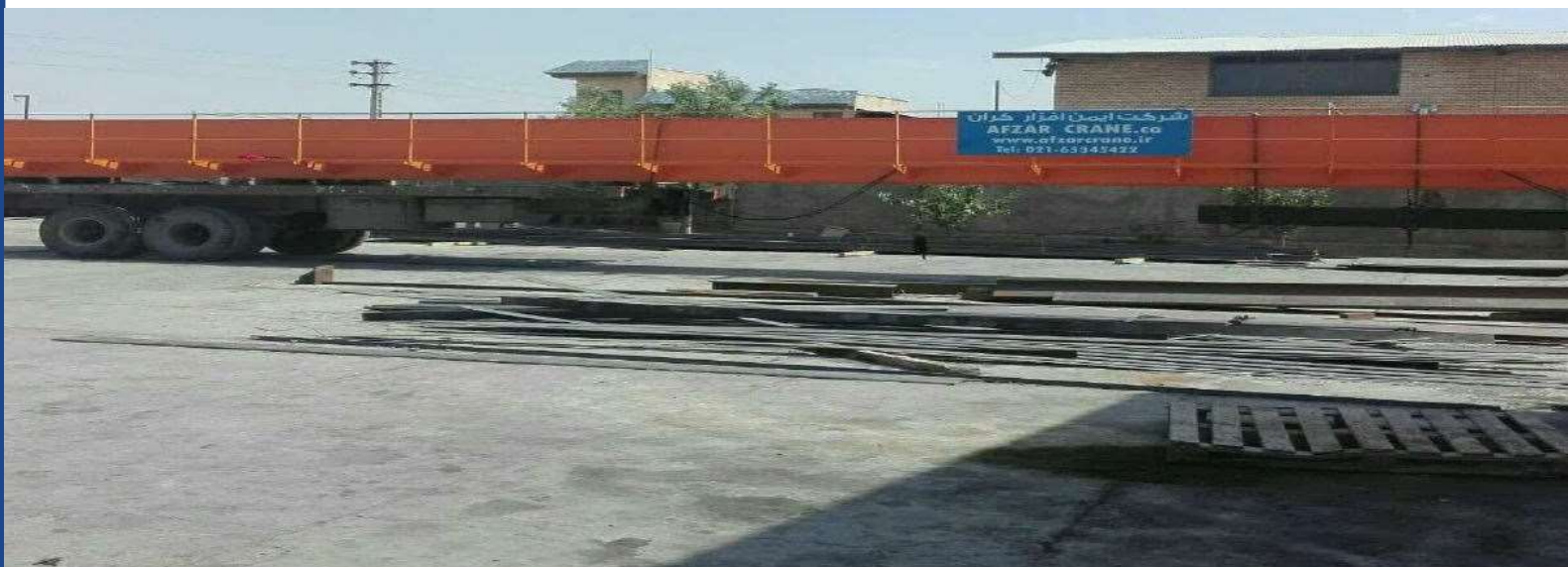
جرثقیل ۵ تن سقفی با دهانه ۲۹ متر
