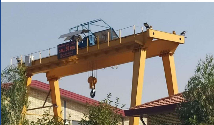
جرثقیل ۳۰ تن دروازه ای با دهانه ۱۵ متر
